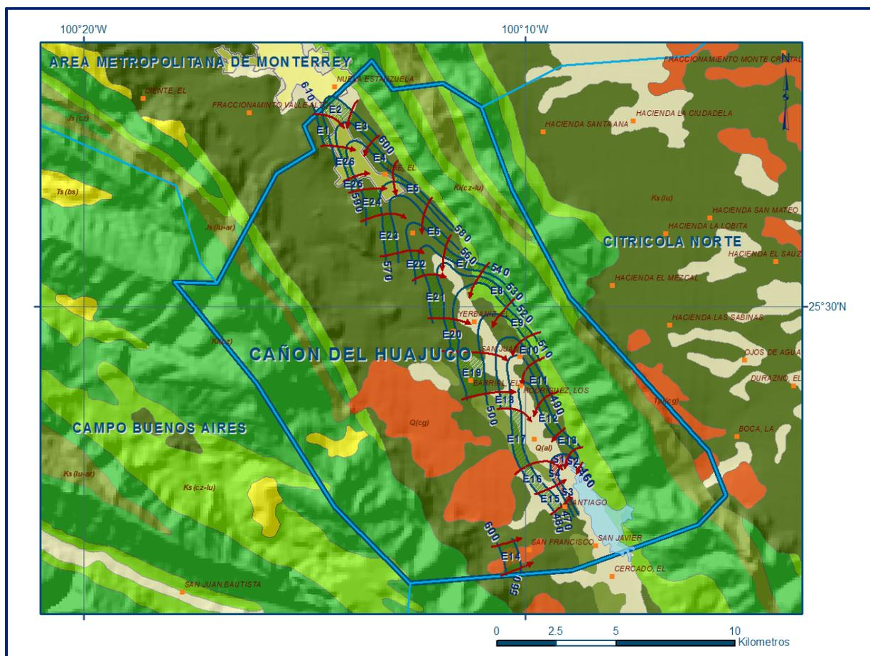
Figura 5. Elevación del nivel estático en msnm (2007)
