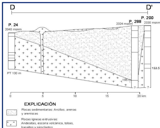
Figura 4. Sección geológica D – D'
