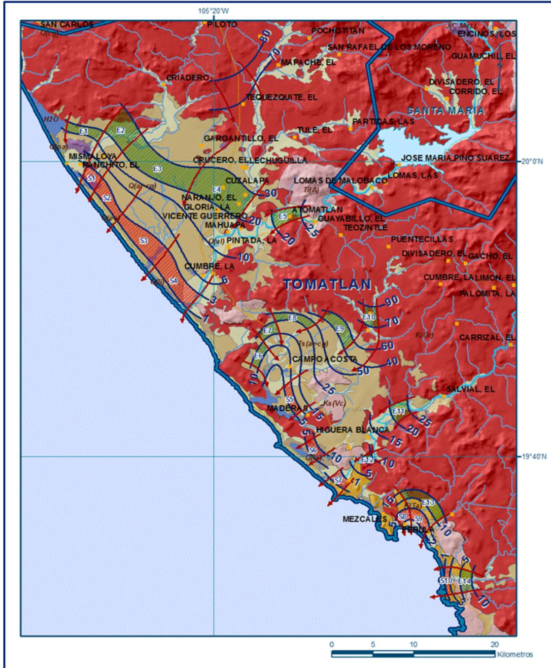
Figura 5. Elevación del nivel estático en msnm (2015)
