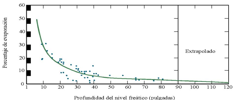
Figura 5. Evaporación del agua Subterránea expresada en %
