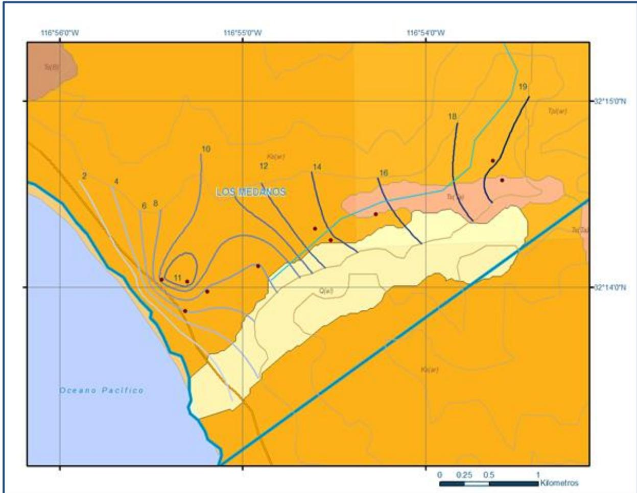
Figura 3. Profundidad al nivel estático en m ( 2008)
